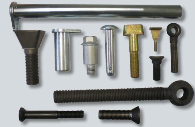
Le nostre attrezzature del reparto di stampaggio, permettono di realizzare una vasta gamma di prodotti sia unificati che a disegno, con quantitativi anche di piccola serie. Particolari finiti, dove richiesto, di trattamenti termici e rettifiche. Si eseguono filettature rullate da M6 a M48, su materiali vari: dal ferro, agli acciai legati, da AISI 303 ad AISI 321/310.
